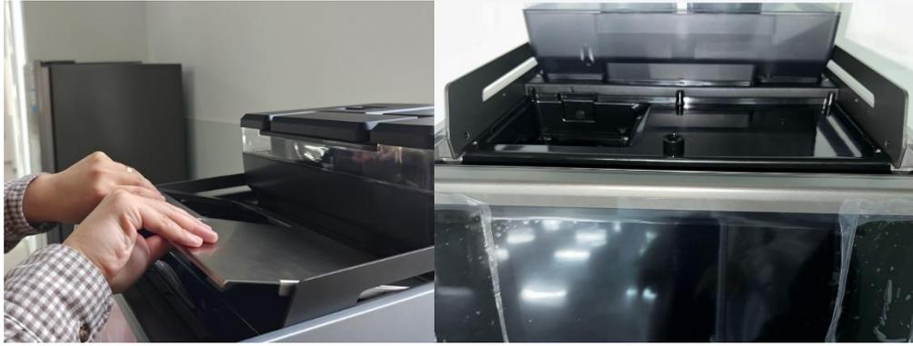
3, 使用 T20 梅花螺丝刀拧松前面板右下侧的固定卡销螺丝, 抬起主屏幕。
