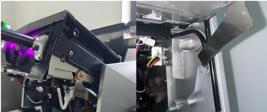
5, 将前面板打开, 断开风扇连接的电源线。
